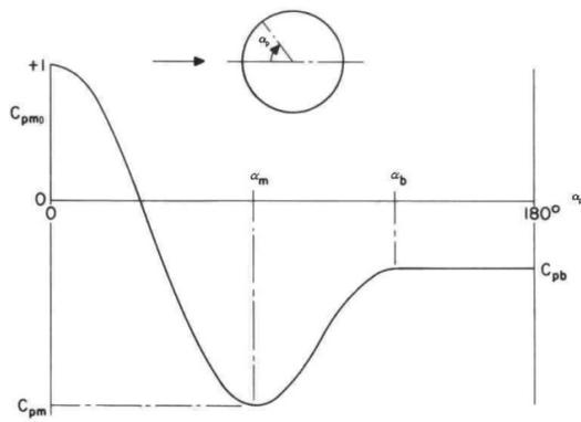
Figura C3.3.26 - Coefficiente di pressione esterna  $c_{pe}$
