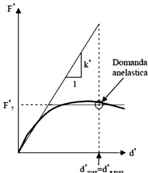
Figura C7.3.2a – Spostamento di riferimento per  $T^* \geq T_c$
