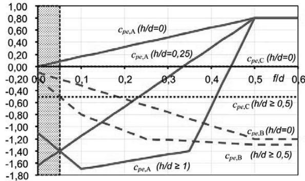
Figura C3.3.27 - Schema di riferimento per cupole sferiche
