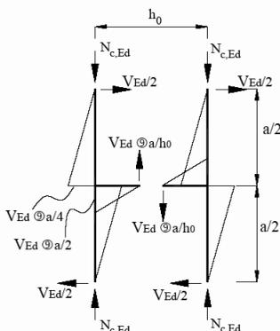
Figura C4.2.9 - Schema di calcolo semplificato per un'asta calastrellata
