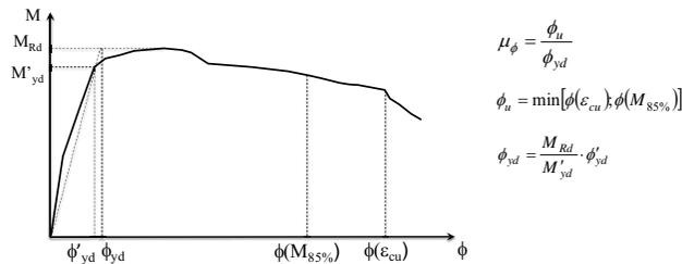
Figura C4.1.12– Relazione momento-curvatura. Fattore di duttilità di curvatura.
