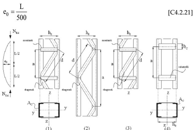
Figura C4.2.7-Aste composte costituite da due correnti uguali
