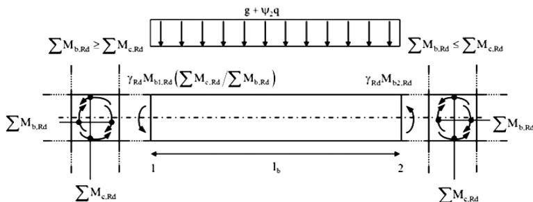
Figura C7.4.1 – Equilibrio dei momenti per il calcolo delle sollecitazioni di taglio di progetto  $V_{E,Ed}$  nelle travi.
