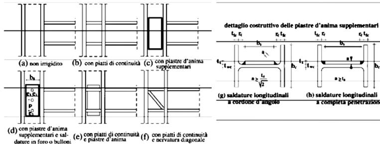
Figura C7.5.2 - Dettagli costruttivi di pannelli nodali irrigiditi
