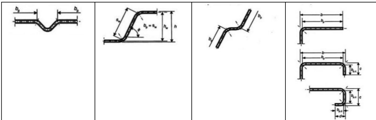
Figura C4.2.27 –Esempi di determinazione della larghezza  $b_p$
