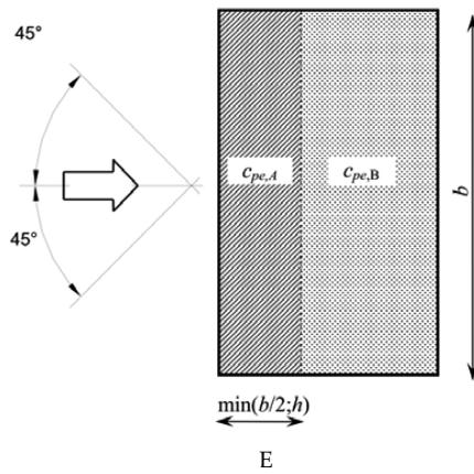
Figura C3.3.5 - Schema di riferimento per coperture piane
