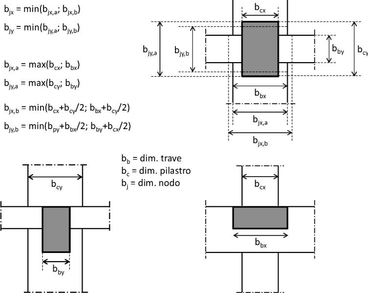
Figura C7.4.3 – Dimensione efficace dei nodi trave-pilastro
