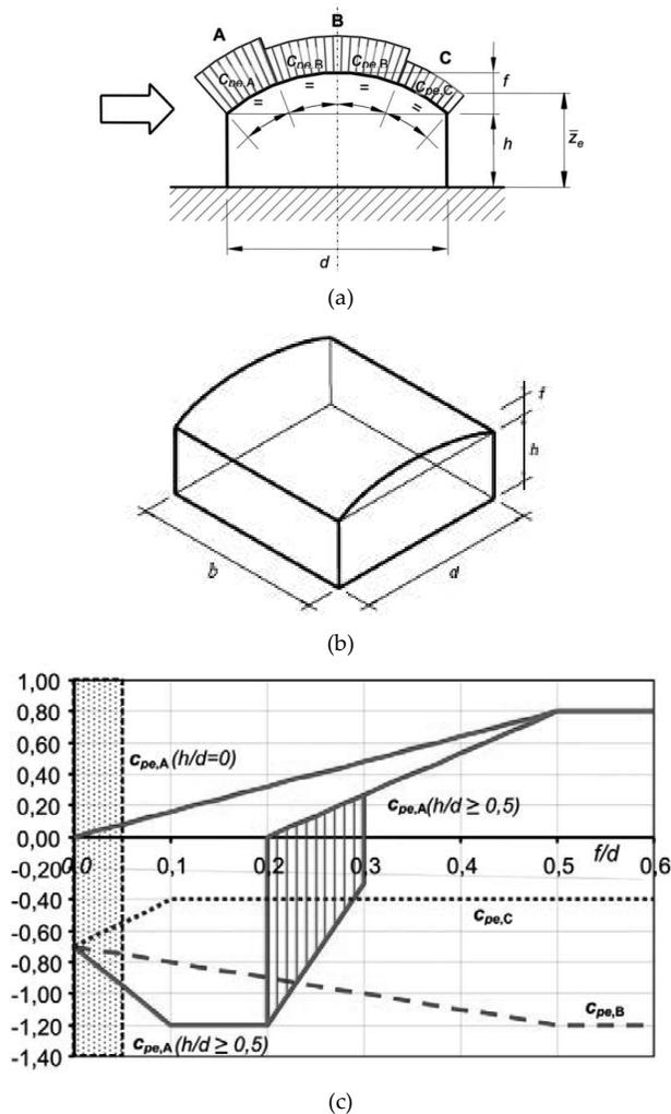
a) e b) Schema di riferimento per coperture a volta cilindrica,
