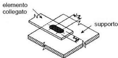
Figura C4.2.36 –Saldature oblunghe a bottone
