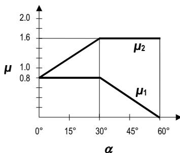
Figura C3.4.2 - Coefficienti di forma per il carico neve
