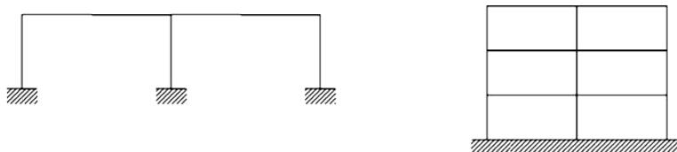
Figura C7.4.4 - Strutture a telaio con collegamenti monolitici
