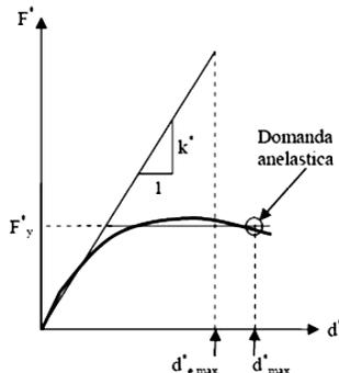
Figura C7.3.2b – Spostamento di riferimento per  $T^* < T_c$
