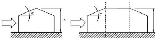
Figura C3.3.15 - Schema delle coperture a padiglione
