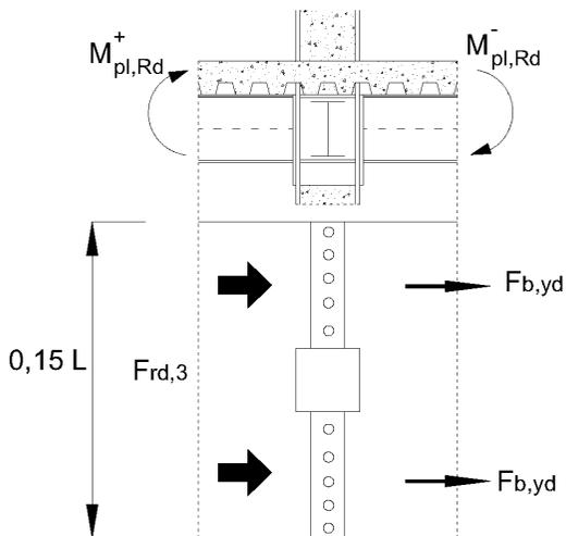
Figura C7.6.5 - Meccanismo 3 – Connettori a taglio sulle travi secondarie
