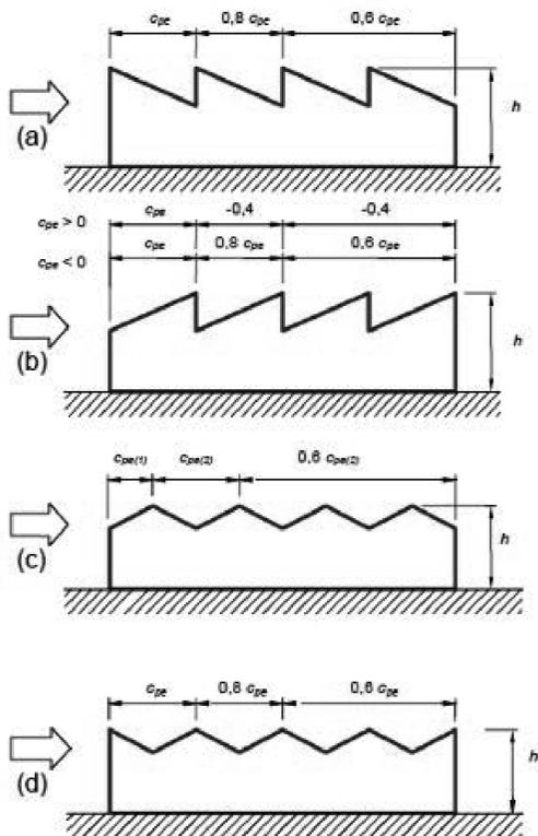
Figura C3.3.18 - Suddivisione delle coperture a falda multipla
