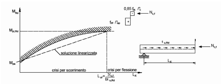
Figura C4.3.9 - Diagramma di interazione parziale calcestruzzo lamiera
