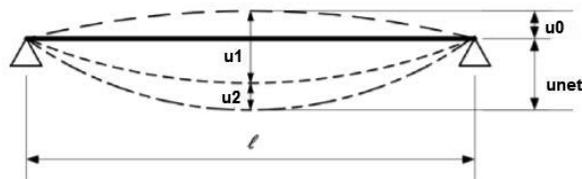
Figura C4.4.1 – Deformazione per un elemento inflesso
