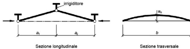
Figura C4.2.18 - Schema di calcolo per gli irrigiditori trasversali
