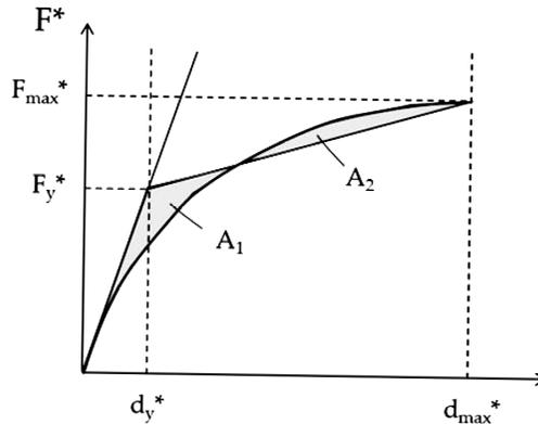
Figura C7.3.3- Bilinearizzazione equivalente
