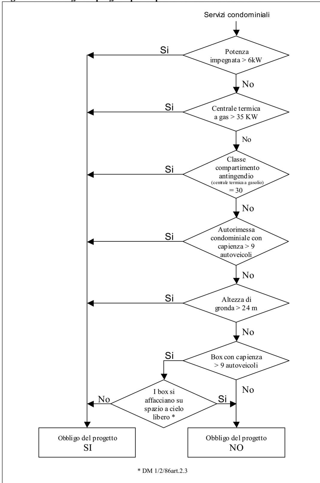
**Fig. AA.3 – Obbligo del progetto per impianti elettrici di locali adibiti ad attività produttive, commerciali, del terziario e altri usi.**
