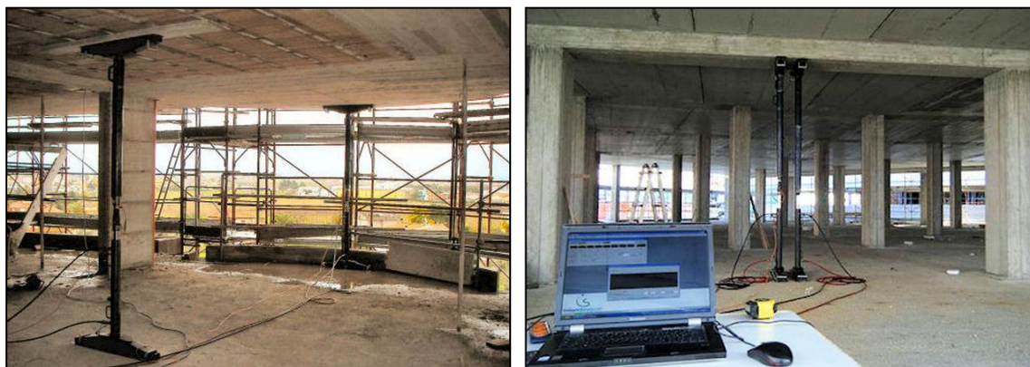
Figura 5.7: Prova a spinta su solaio e trave
