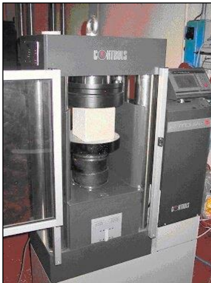
Figura 4.1: Macchina a compressione monoassiale
