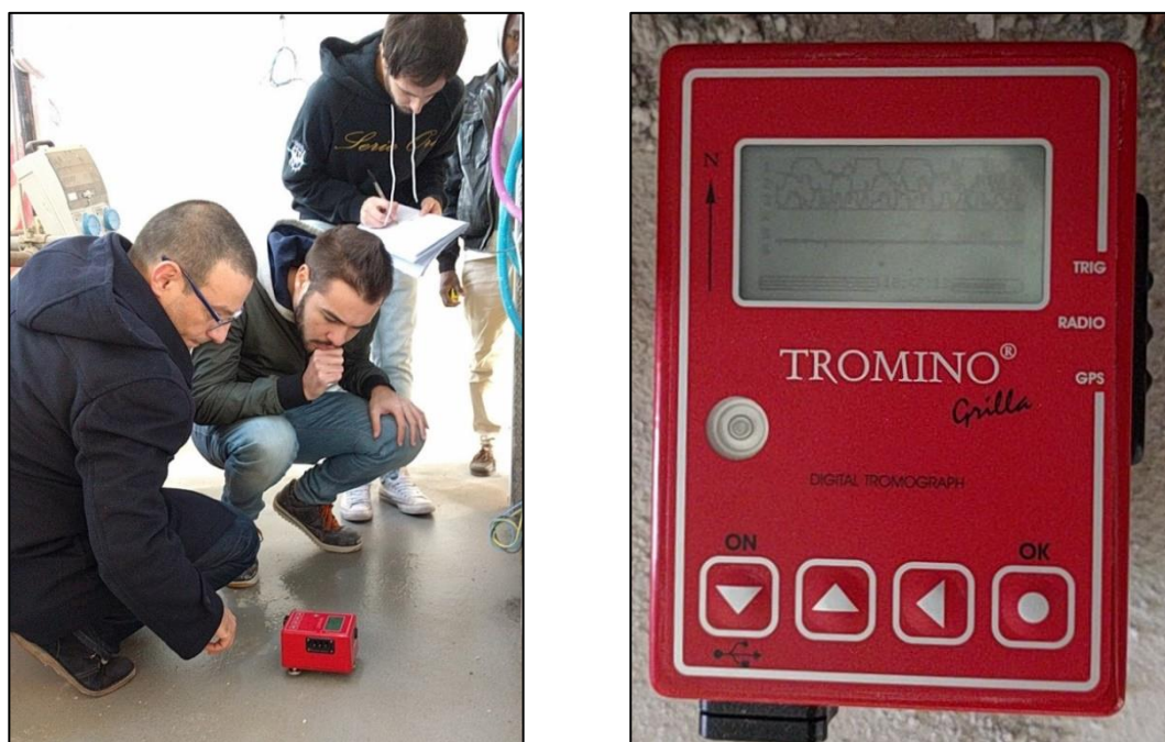
Figura 6.11: A sinistra, fasi di stazionamento e settaggio del TROMINO. A destra, la strumentazione è pronta per la registrazione
